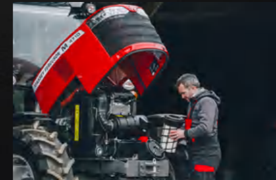
A motor légszűrője könnyen hozzáférhető és tisztítható.
