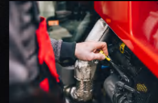
A mellső híd és a „karcúsított” motorháztető kialakításának köszönhetően az olajsínt-ellenőrző nívópálca és a szűrő is könnyen hozzáférhető.
