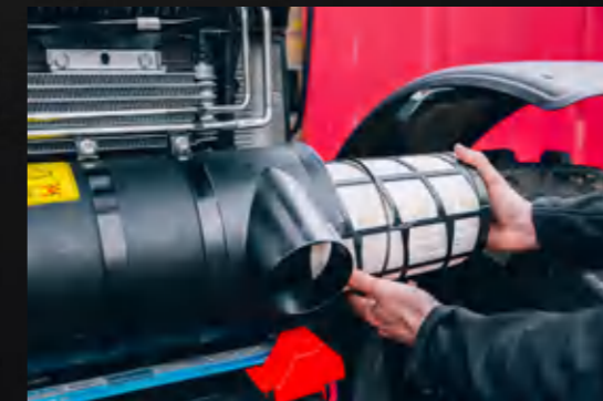
A motor légszűrője könnyen hozzáférhető és tisztítható.
