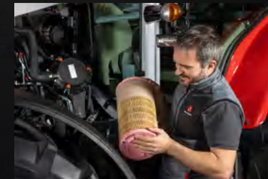
A motor légszűrője könnyen hozzáférhető és tisztítható.
