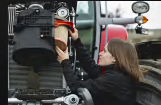
A motor légszűrője könnyen hozzáférhető és tisztítható.
