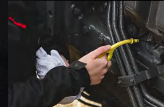
A mellő híd és a „karcsúsított” motorháztető kialakításának köszönhetően az olajsint-ellenőrző nívópálca és a szűrő is könnyen hozzáférhető.
