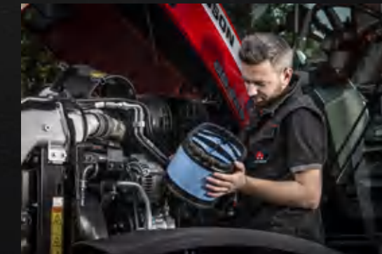
A motor légszűrője könnyen hozzáférhető és tisztítható.
